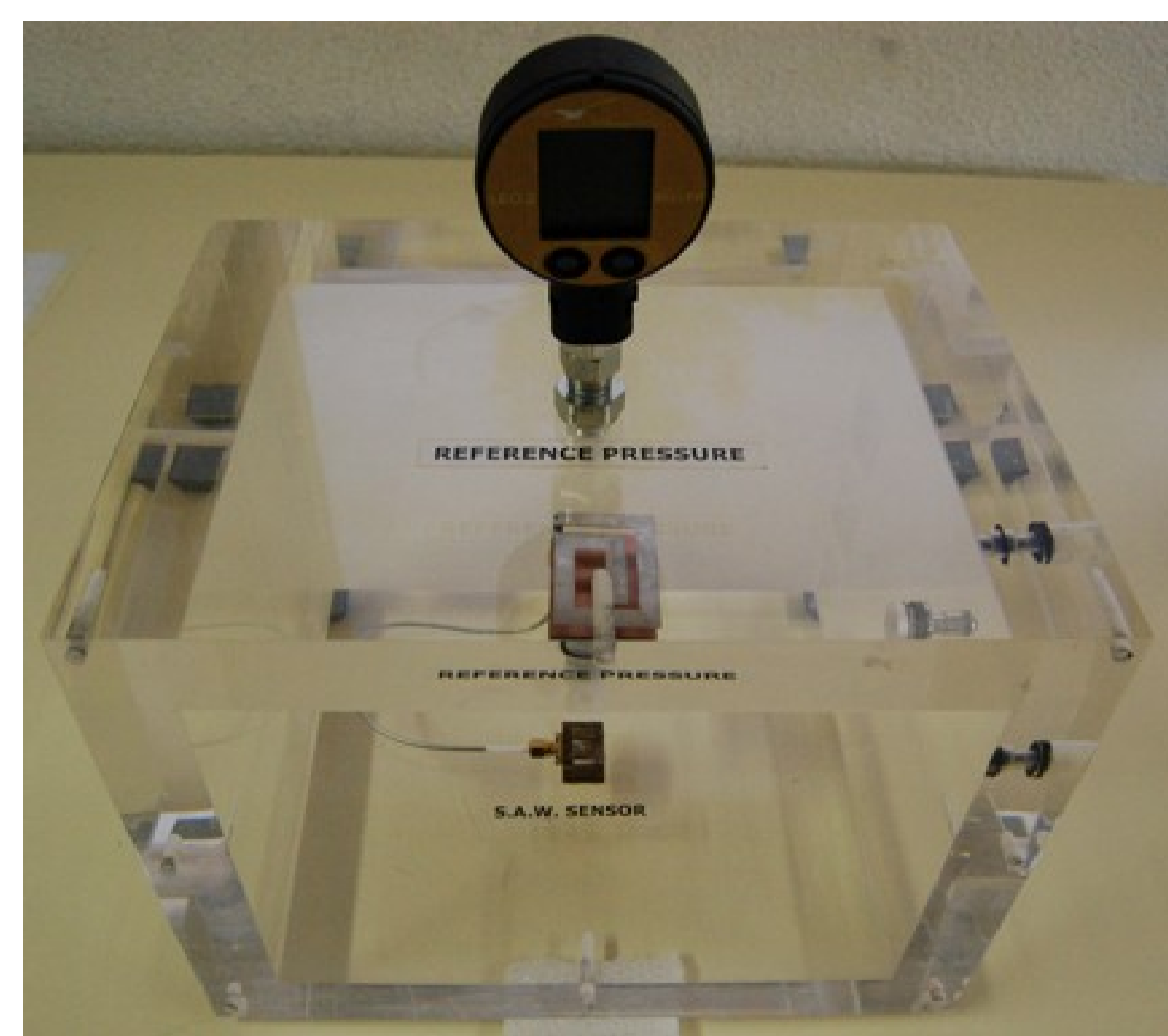
Cavité en plexiglas avec capteur, antenne et manomètre
