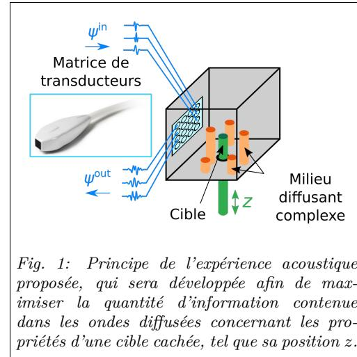
Fig. 1: Principe de l'expérience acoustique proposée, qui sera développée afin de maximiser la quantité d'information contenue dans les ondes diffusées concernant les propriétés d'une cible cachée, tel que sa position  $z$ .
