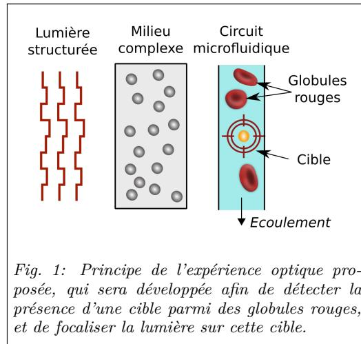
Fig. 1: Principe de l'expérience optique proposée, qui sera développée afin de détecter la présence d'une cible parmi des globules rouges, et de focaliser la lumière sur cette cible.
